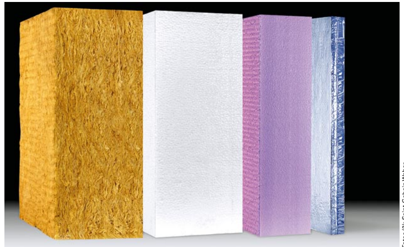
In den Fasern oder Poren gängiger Dämmstoffe ist Luft als schlechter Wärmeleiter eingeschlossen. Noch besser dämmt ein Vakuum
